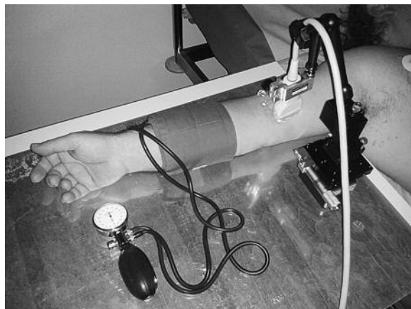
Εικόνα 1. Ακινητοποίηση κεφαλής υπέρηχου σε θέση με διανγή απεικόνιση βραχιονίου αρτηρίας και ταυτόχρονη τοποθέτηση σφυγμομανόμετρον στο αντιβράχιο.
